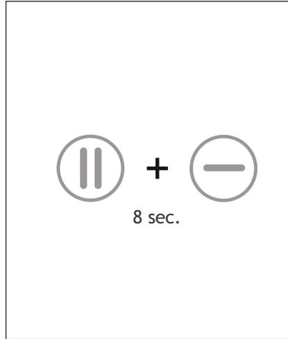
2. Schalten Sie Ihr Gerät in den Service-Modus, indem Sie die obenstehende Tastenkombination 8 Sekunden lang eindrücken. Alle LED-Leuchten brennen. 1 Minute warten, damit sich die Klappen schließen können.
