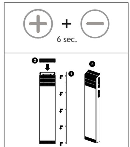
6. Setzen Sie den Filterstundenzähler zurück, indem Sie die obige Tastenkombination 6 Sekunden lang drücken. Die Meldung "Filter verschmutzt" verschwindet. Drücken Sie eine beliebige Taste, um den Servicemodus zu verlassen.
