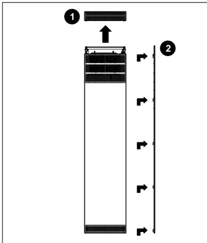
1. Entfernen Sie zunächst das obere Gitter des Geräts (1). Dann die rechte Seitenpaneele (2). Hier ist das interne Bedienfeld angebracht.
