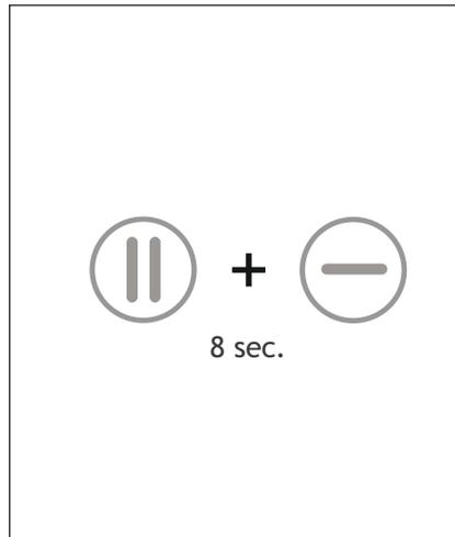
2. Schalten Sie Ihr Gerät in den Service-Modus, indem Sie die obenstehende Tastenkombination 8 Sekunden lang eindrücken. Alle LED-Leuchten brennen. 1 Minute warten, damit sich die Klappen öffnen können.
