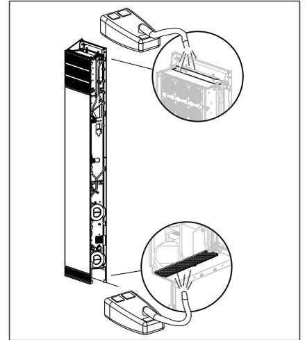
3. Das Insektennetz an der Ober- und Unterseite des Units mit dem Staubsauger reinigen.
