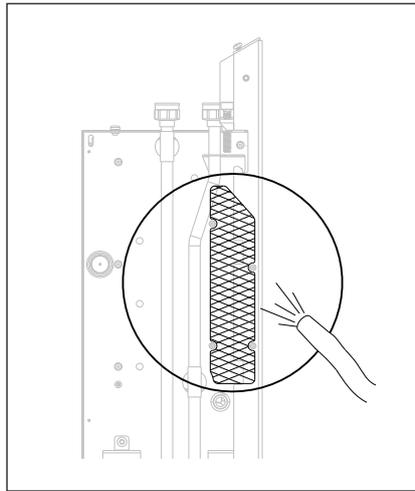
5. Das Insektennetz an beiden Seiten des Konvektors mit dem Staubsauger reinigen.
